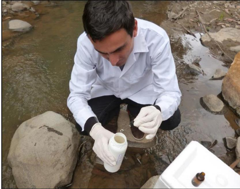
**Foto N° 09:** Adición de 25 gotas de preservante ( $\text{HNO}_3$  – Ácido Nítrico)
