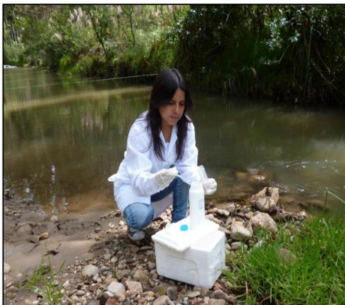
**Foto N° 12:** Adición de 25 gotas de preservante ( $\text{HNO}_3$  – Ácido Nítrico)
