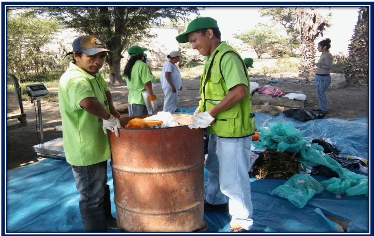
Figura 35: Pesado y medición de residuos sólidos en el cilindro para determinar la densidad.
