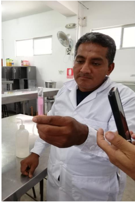
Figura 10. Prueba el cloro DPD se colorea lila Figura 11. La adsorción del carbón activado incoloro
