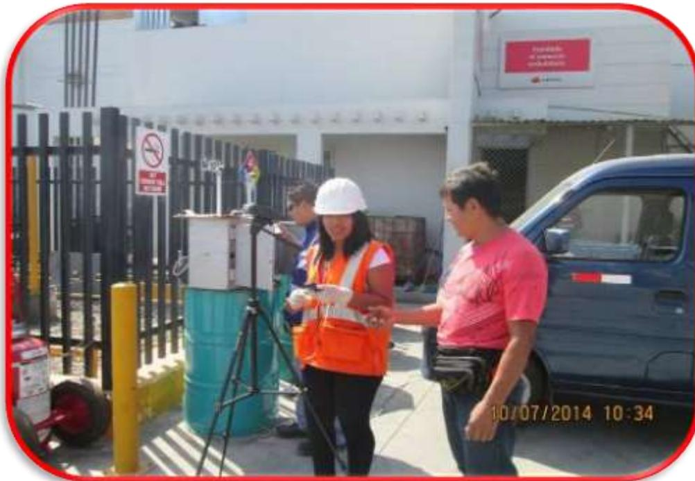
Imagen 8.- Tren de muestreo – Medición de gases
