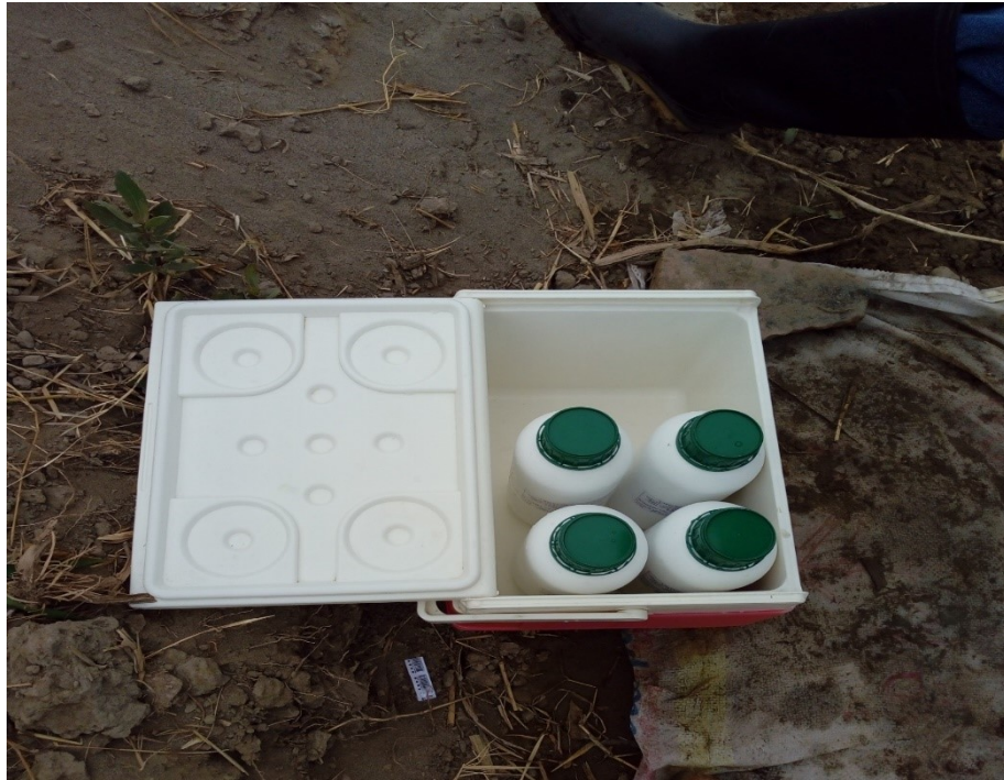
Figura 12. Muestras de agua almacenadas en un cooler de plástico de polietileno de alta densidad. Fuente: Elaboración propia.
