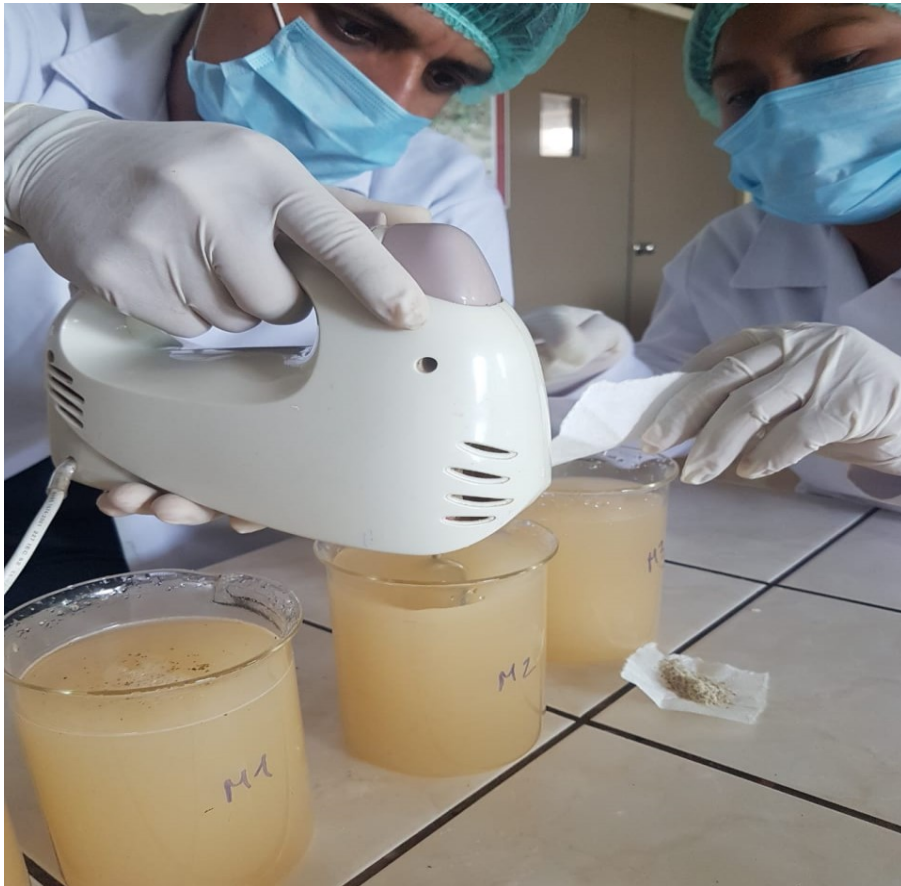
Figura 16. Adición del coagulante natural a la muestra de agua y mezclado a la vez. Fuente: Elaboración propia.
