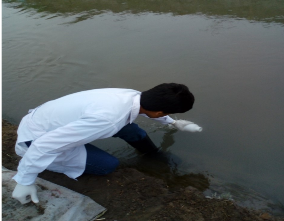
Figura 10. Recolección de agua del canal Monsefú en botellas de plástico de polietileno de alta densidad.
