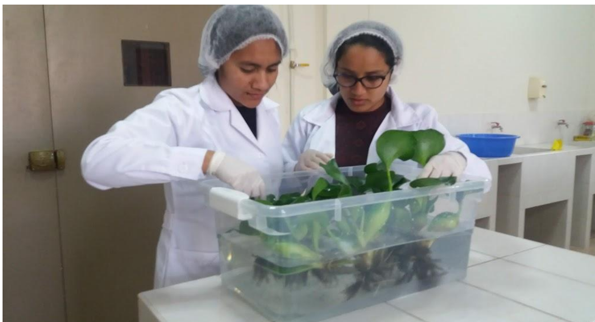
Figura 17. Recipiente de fitorremediación con Jacinto de agua ( Eichhornia crassipes ) para el agua de pozo del centro poblado Cruz del Médano-Mórrope a escala de laboratorio.
