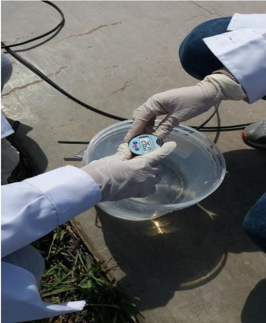
Figura 13. Medición de la temperatura del agua sacada del pozo.
