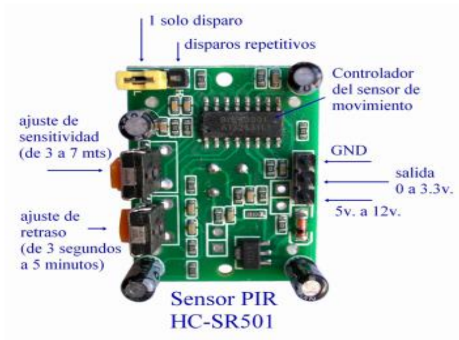
Figura N° 19. Características del sensor PIR
