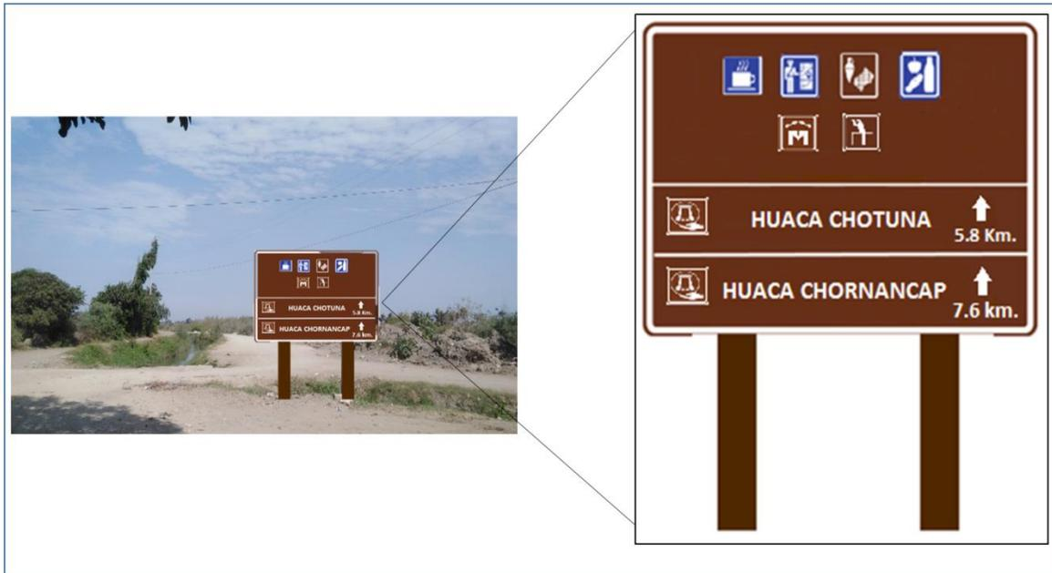
Figura 25: Señal tipo O1: Señal informativa de Pre-señalización de destino en vías vehiculares
