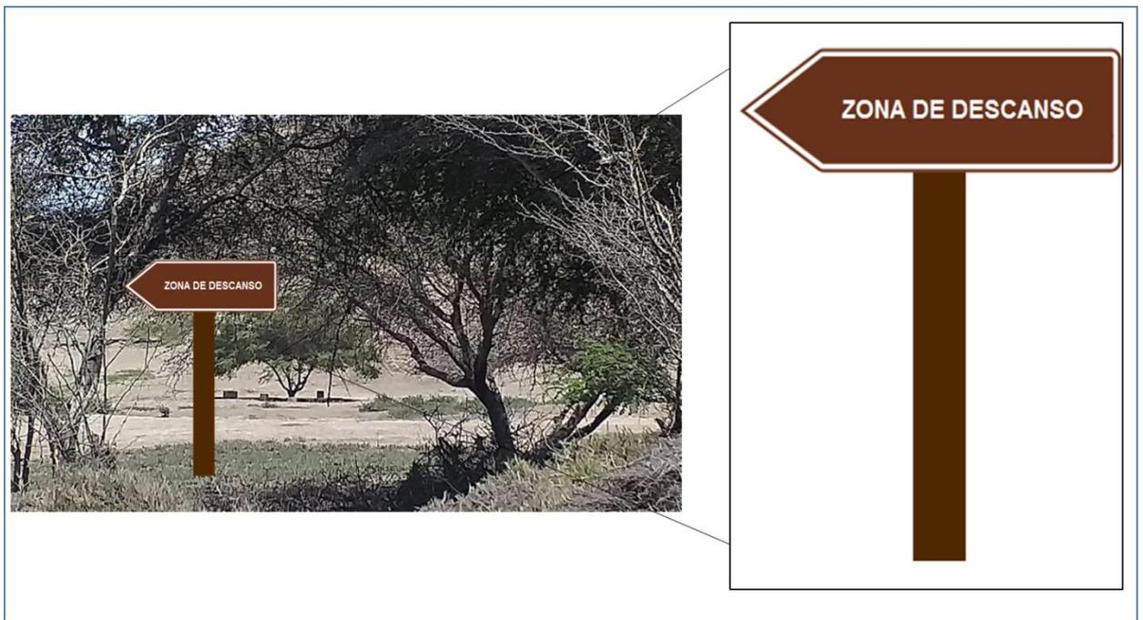
Figura 41. Señal tipo Flecha: vías peatonales internas
