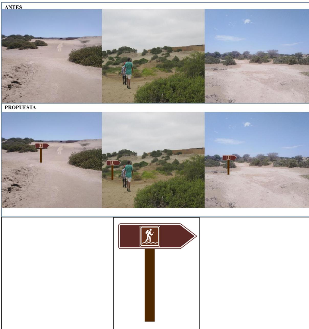
Figura 38. Señal tipo Flecha: vías peatonales internas
