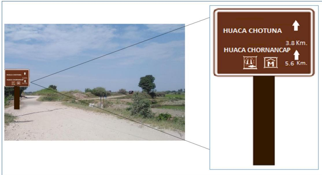
Figura 27. Señal tipo O1: Señal informativa de Pre-señalización de destino en vías vehiculares
