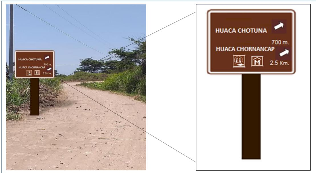
Figura 33. Señal tipo O1: Señal informativa de Pre-señalización de destino en vías vehiculares
