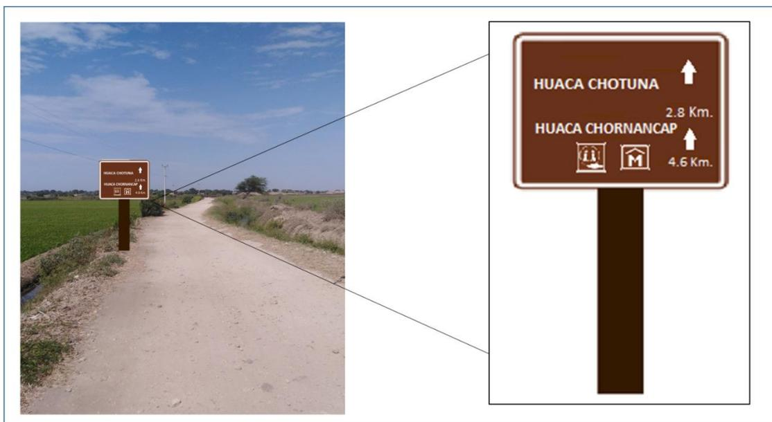
Figura 28. Señal tipo O1: Señal informativa de Pre-señalización de destino en vías vehiculares
