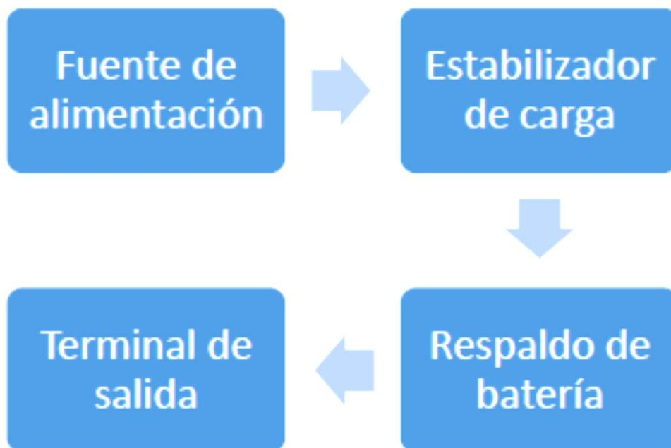
**Diagrama 1:** Diagrama de bloques del cargador portátil.
