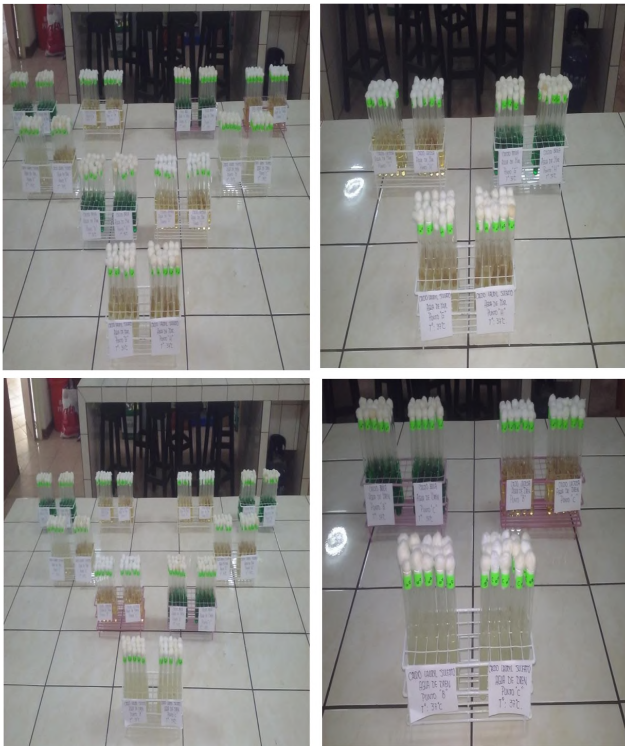
FIGURA 26, 27, 28 Y 29.- OBSERVANDO EL CRECIMIENTO DE LOS COLIFORMES TOTALES Y FECALIS; UTILIZANDO CALDO BRILA, CALDO SULFATO LAURYL Y CALDO LACTOSA, OBSERVANDO LA PRESENCIA DE TURBIDEZ Y REDUCCIÓN DE GAS EN LAS CAMPANAS.
