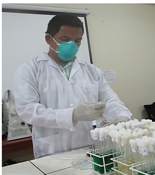
FIGURA 22, 23, 24 Y 25.- REALIZANDO EL ANÁLISIS MICROBIOLÓGICO UTILIZANDO LA TÉCNICA DEL NÚMERO MÁS PROBABLE PARA COLIFORMES TOTALES Y FECALES; UTILIZANDO CALDO BRILA, CALDO SULFATO LAURYL Y CALDO LACTOSA.
