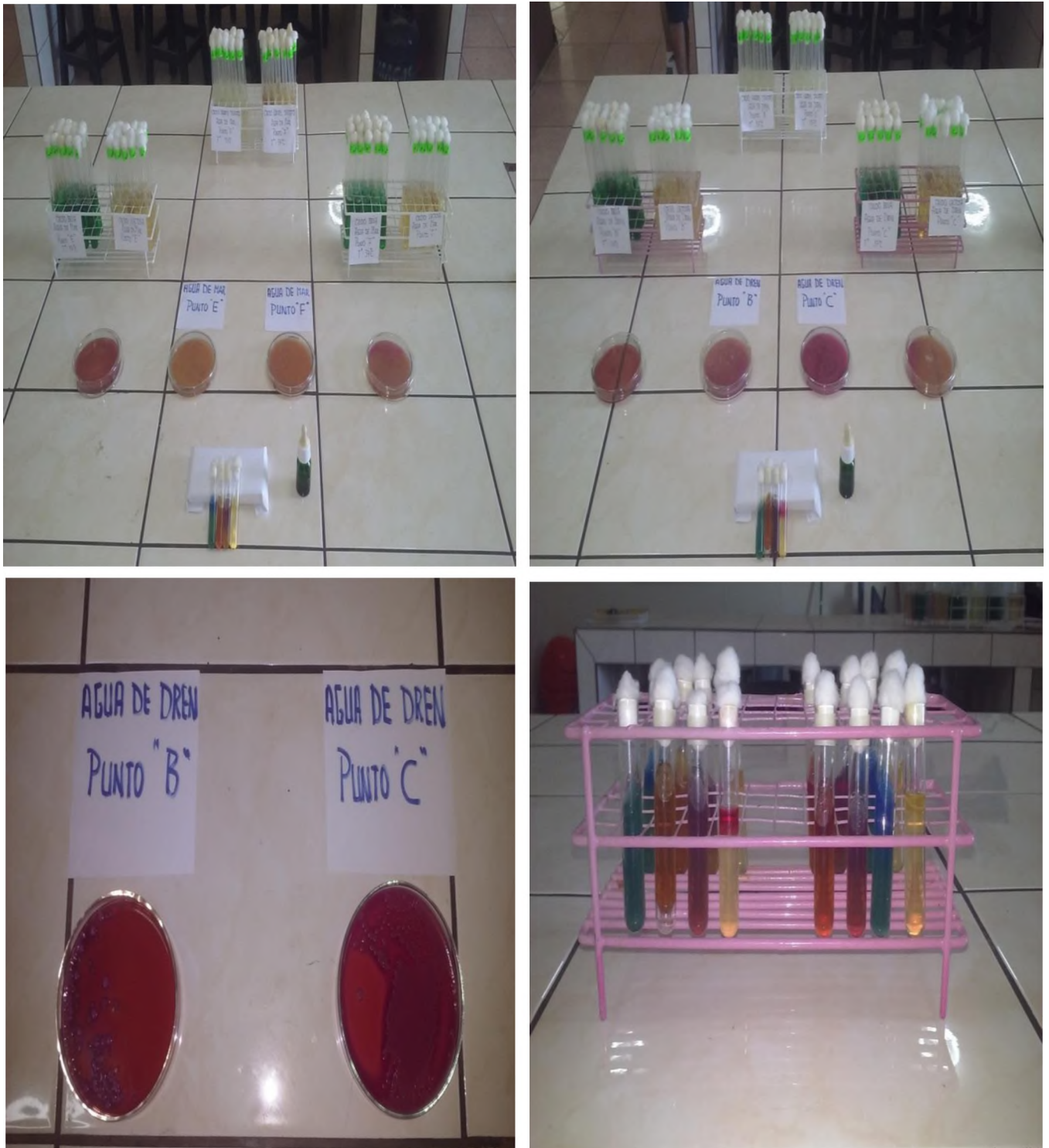
FIGURA 38, 39, 40 Y 41.- IDENTIFICACIÓN DE LOS COLIFORMES FECALES Y TOTALES UTILIZANDO PRUEBAS BIOQUÍMICAS: TSI, LIA, CITRATO Y SIM.
