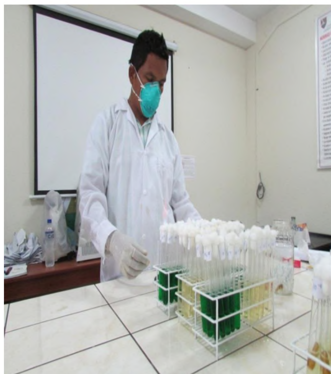
FIGURA 22, 23, 24 Y 25.- REALIZANDO EL ANÁLISIS MICROBIOLÓGICO UTILIZANDO LA TÉCNICA DEL NÚMERO MÁS PROBABLE PARA COLIFORMES TOTALES Y FECALES; UTILIZANDO CALDO BRILA, CALDO SULFATO LAURYL Y CALDO LACTOSA.
