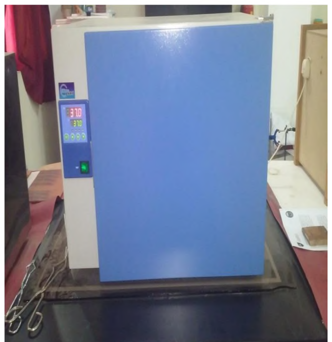
FIGURA 34, 35, 36 Y 37.- FINALIZADA LA SIEMBRA DE LOS TUBOS QUE PRESENTARON TURBIDEZ Y PRODUCCIÓN DE GAS, SE LLEVARON LOS MEDIOS A UNA INCUBADORA A UN TEMPERATURA DE 37°C /24 HORAS.
